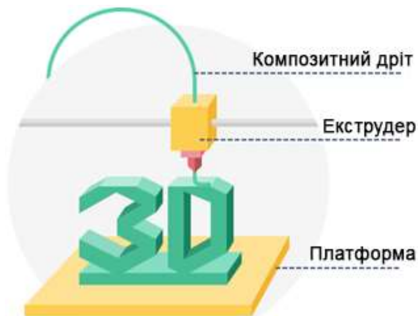
Рисунок. 1. Принцип роботи 3D принтера технології FDM.
