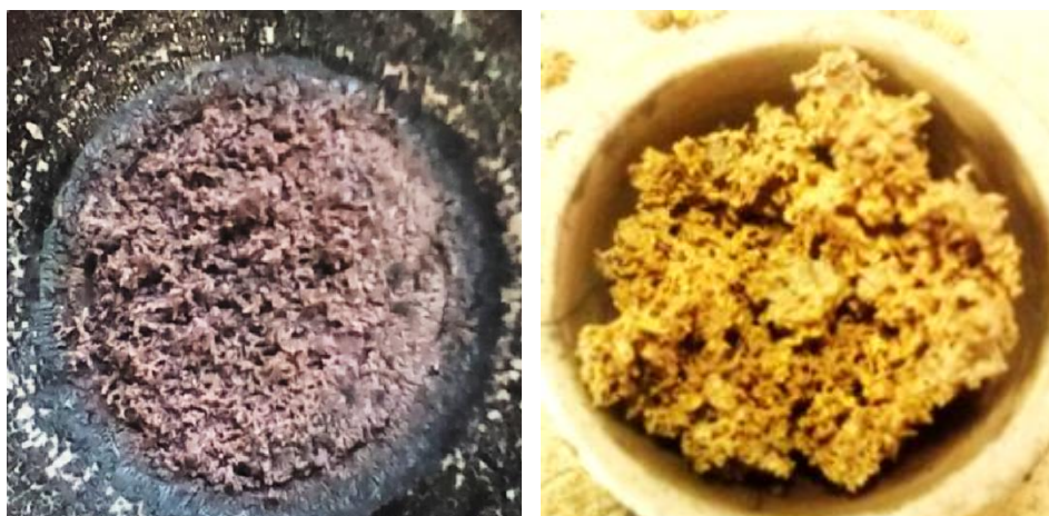
Рис. 3.2. Отримані нанорозмірні порошки \text{LaCrO}_3 (а) та \text{LaFeO}_3 (б)
